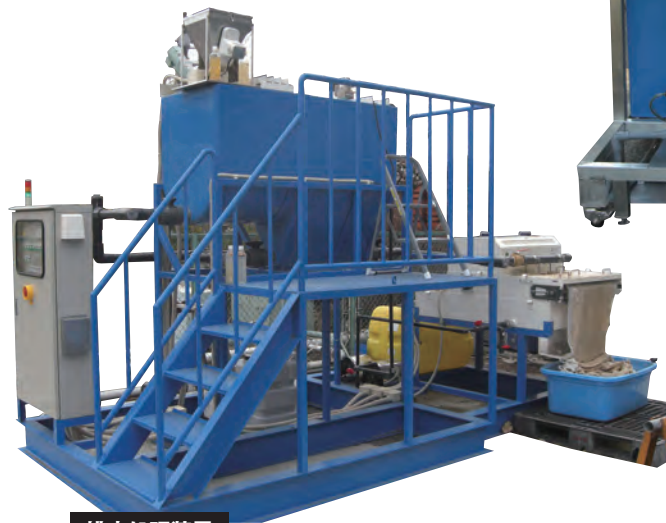
排水処理装置
