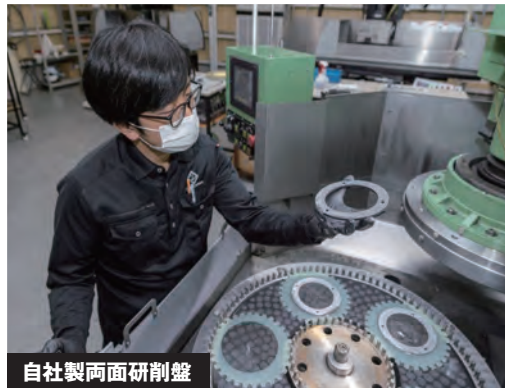
自社製両面研削盤
